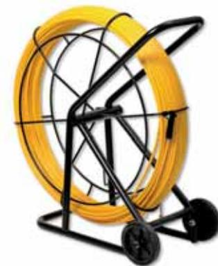
Guía pasa-cables de Fibra de Vidrio de Ø 9 mm y 80 metros de longitud, protegida con funda de polipropileno de gran resistencia, color amarillo, provista con terminales intercambiables y accesorios incluidos: cabeza guía flexible de 14 mm Ø, rollana de aluminio Ø 53 mm, suministrado en contenedor metálico VH800 provisto de anilla guía, freno de seguridad, soporte accesorios y ruedas de transporte.
